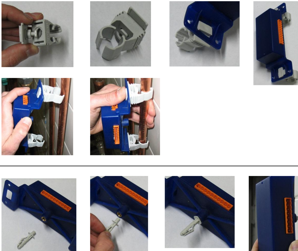
Afbeelding 4: Aansluitingen op de UCU (Urinal & Toilet)
